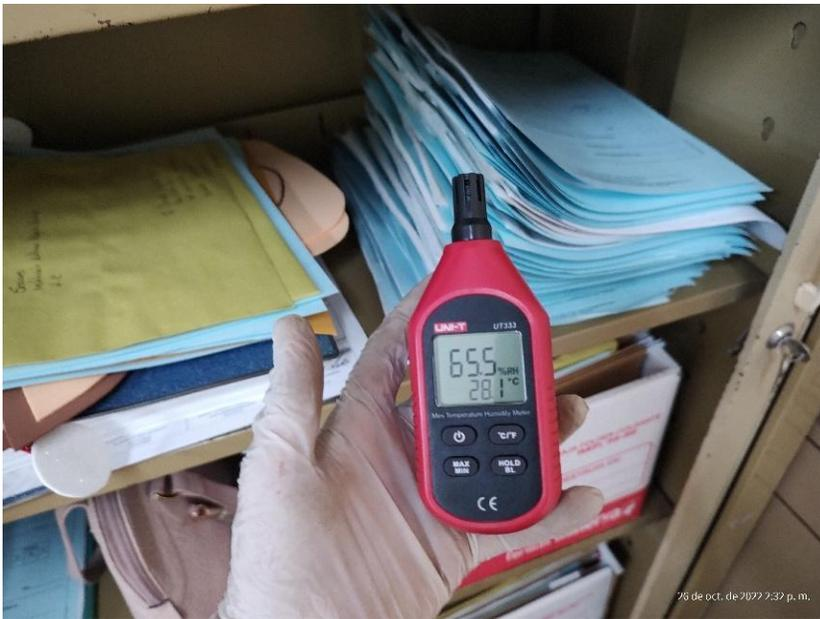
*Ilustración 11. Medición de temperatura y humedad relativa.*
