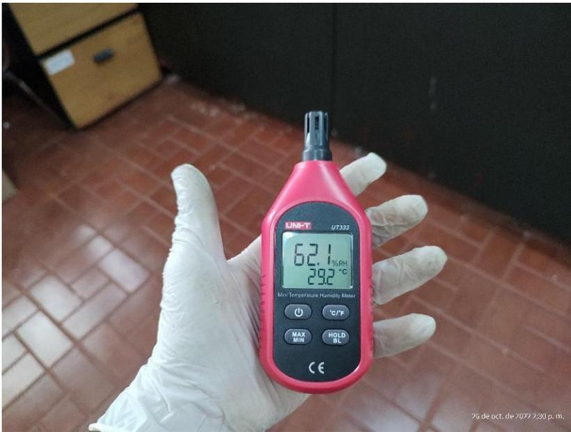
*Ilustración 10. Medición de temperatura y humedad relativa.*
