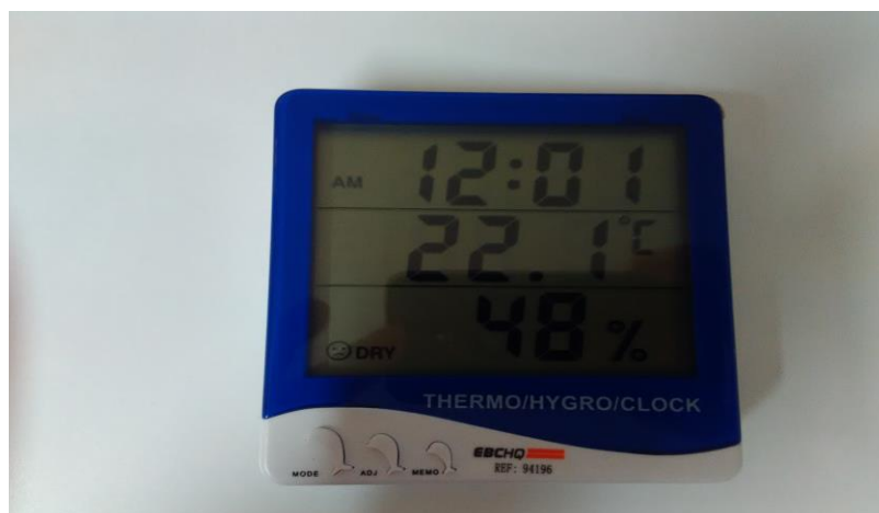
Fotografía No.3 Medidor de temperatura y humedad relativa, 05/05/2020
