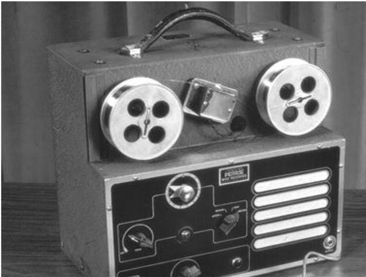
Ilustración 16 Magnetófono de alambre
